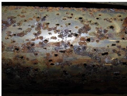
Figure 2 - Corrosion par piqûres sur un conduit
