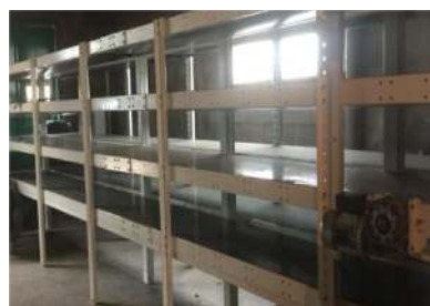
Installation de 4 convoyeurs charges lourdes de 60 cm de largeur dans un container
