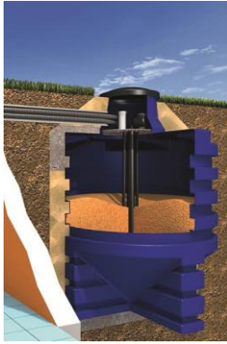
Figure 6: silo enterré en plastique avec prélèvement par le bas
